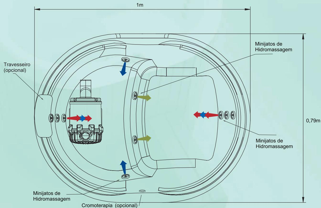
\* Dimensões em milímetros // \*Imagens meramente ilustrativas. As medidas e disposição dos jatos podem conter variações. // \* Acesso mínimo a manutenção: 500mm x 500mm (comprimento x altura).
