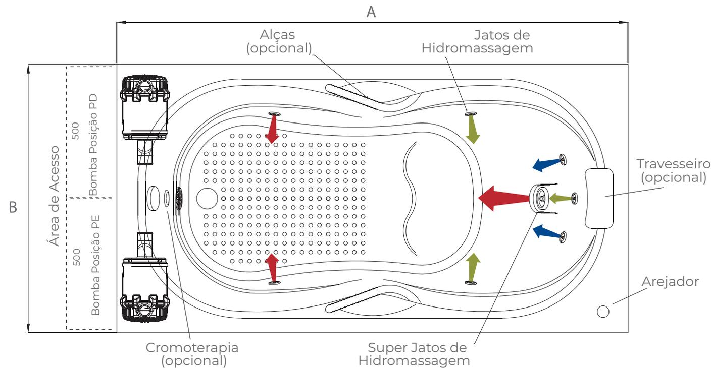
\*Dimensões em milímetros // \* Imagens meramente ilustrativas. As medidas e disposição dos jatos podem conter variações. // \* Acesso mínimo a manutenção: 500mmx350mm (comprimento x altura).
