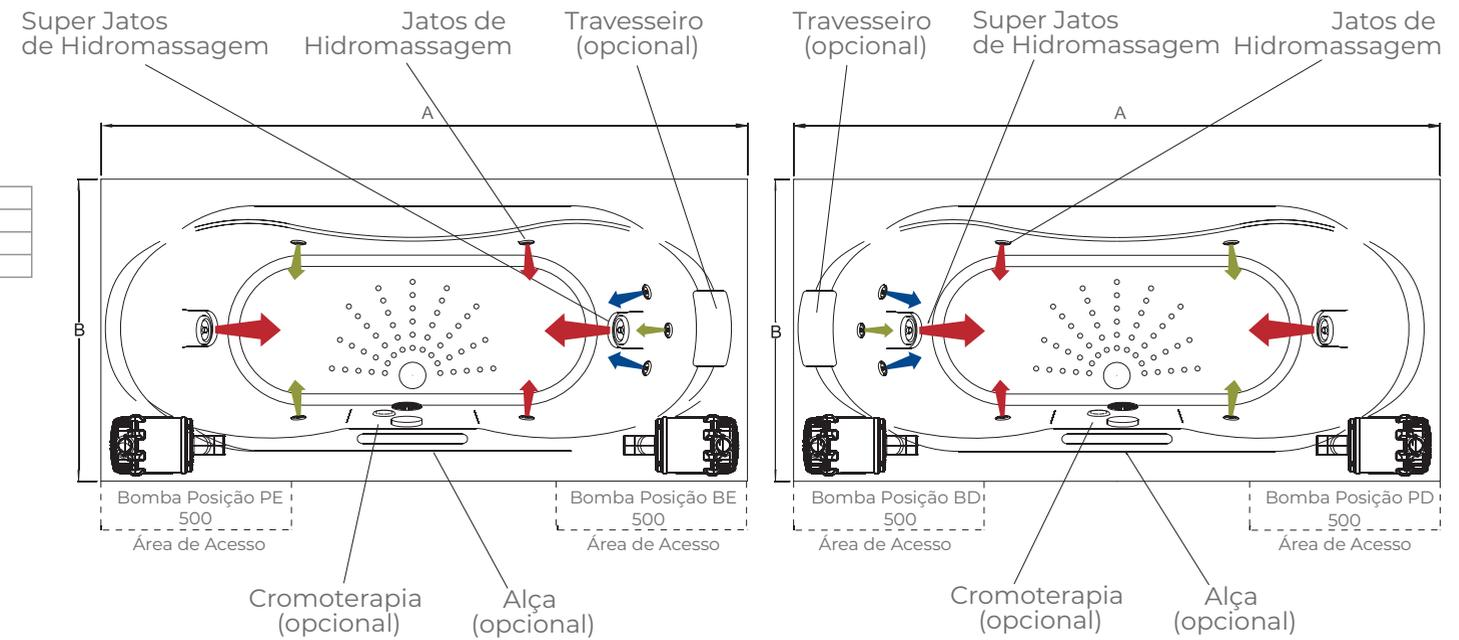
\*Dimensões em milímetros // \* Imagens meramente ilustrativas. As medidas e disposição dos jatos podem conter variações. // \* Acesso mínimo a manutenção: 500mmx350mm (comprimento x altura).
